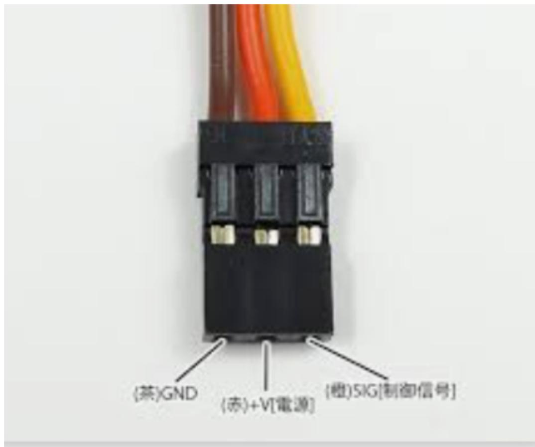
**サーボのケーブルをロボットに挿すときは向きに注意してください。**
