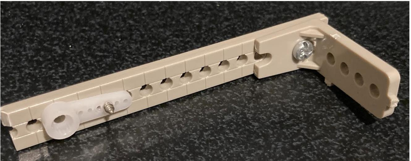
L字パーツを反対側に写真のようにネジでしっかり取り付けます。
